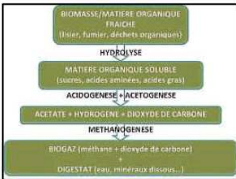
Schéma de la production du biogaz
